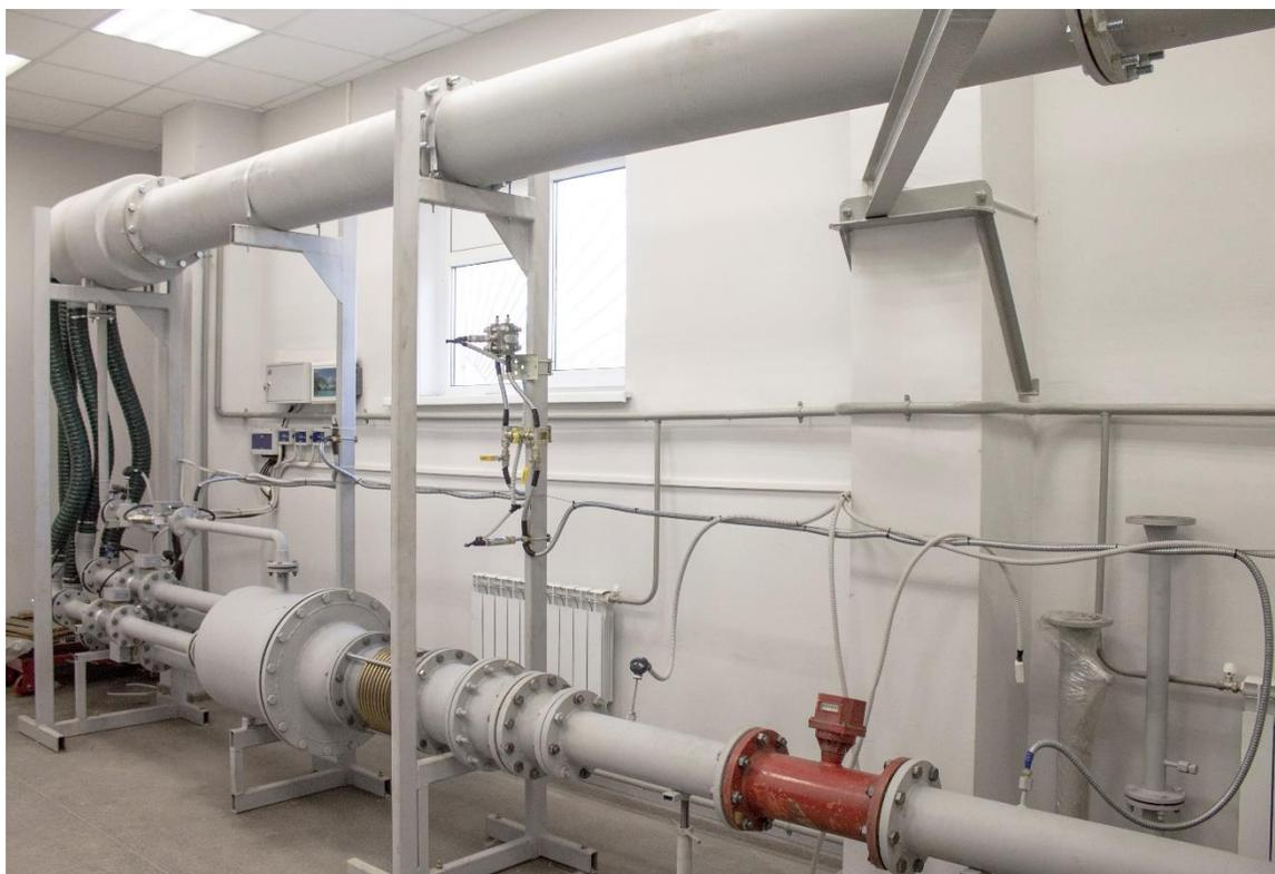
Рисунок 1 — Общий вид измерительной части установки поверочной Ирга-ПУ-МС
